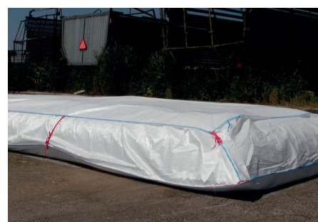
Naplnený flexitank so záchytnou vaňou
