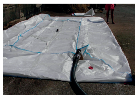
Naplnený flexitank so záchytnou vaňou
