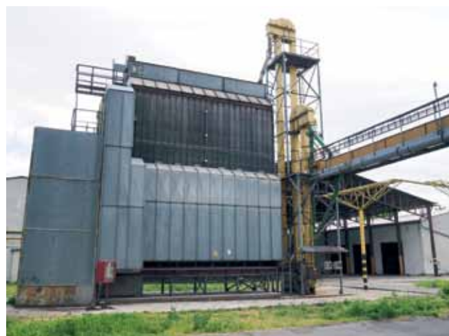
Sušička obilia typu MC (MATHEWS Company) model – 975 so samostatne stojacim ovládacím panelom.
