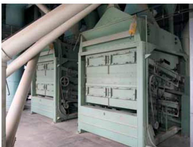
Čističky typu ASP-750 vyrobené v roku 1990 s výkonom 70 t/h.
